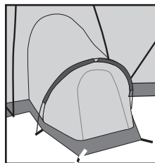
ill. 9 Abri niche monté, illustré avec son mât et ses piquets
