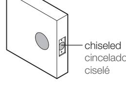
Si el borde de la puerta está cincelado, instale la placa trasera y la placa frontal rectangular.
