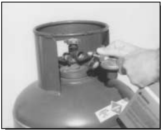
Regulador con orificio de ventilación hacia abajo
