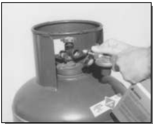
Régulateur avec purgeur orienté vers le sol
